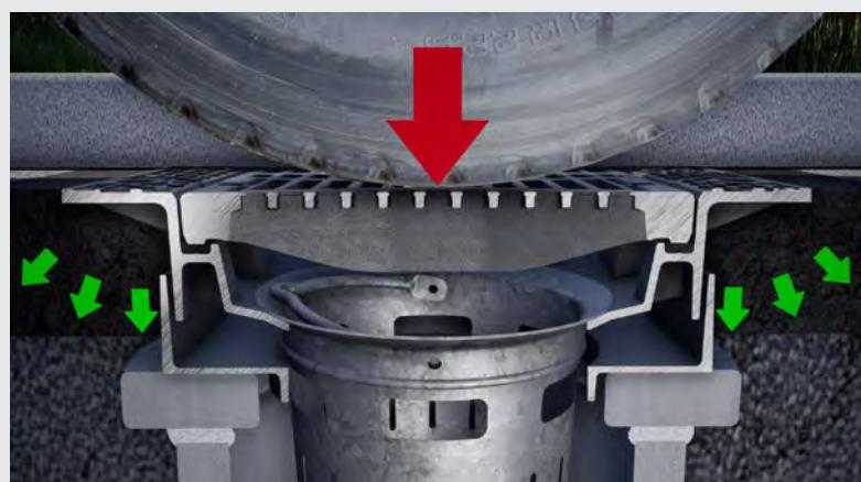
ACO Multitop Bituplan slivne rešetke nemaju direktni kontakt sa telom sливника. Saobraćajna opterećenja su skoro potpuno preusmerena van okvira sливника, a telo sливника je rasterećeno tako da nema pojave udarnog opterećenja na sливник i prenosa sile na konstrukciju.
