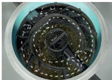
Feinseparation durch lange Fließstrecke
