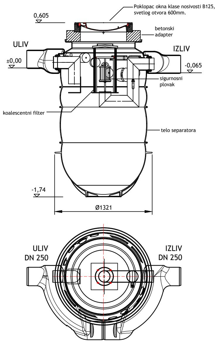
Prilikom montaže (slaganja) elemenata kontrolisati spojeve i njihovu nepropusnost.
