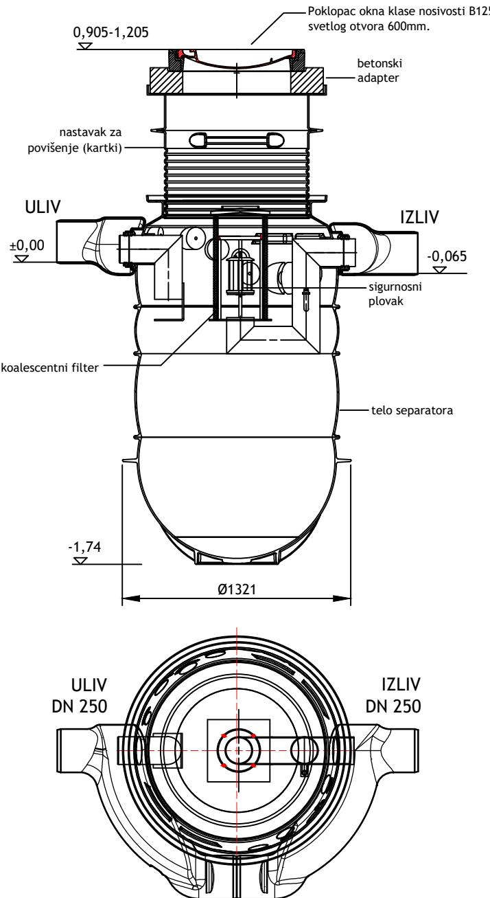
Prilikom montaže (slaganja) elemenata kontrolisati spojeve i njihovu nepropusnost.
