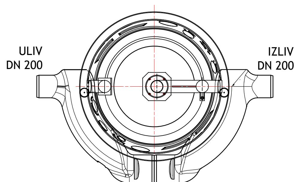
Prilikom montaže (slaganja) elemenata kontrolisati spojeve i njihovu nepropusnost.
