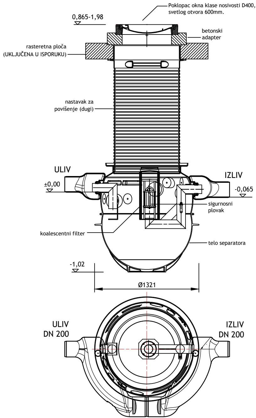
Prilikom montaže (slaganja) elemenata kontrolisati spojeve i njihovu nepropusnost.
