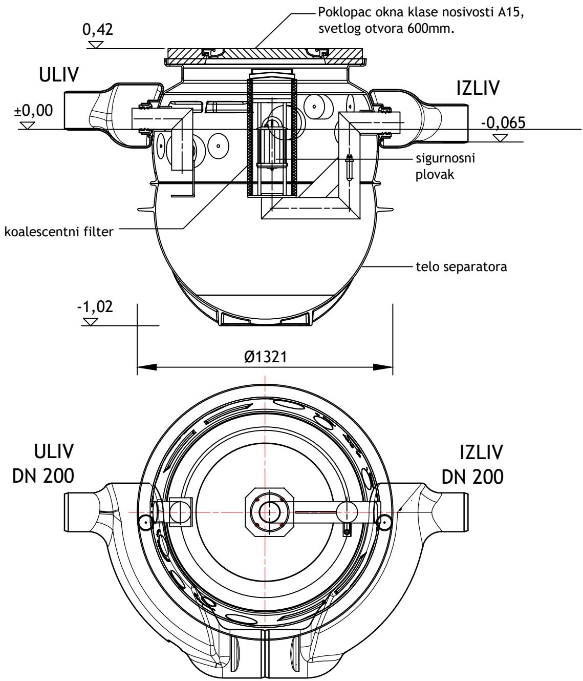
Prilikom montaže (slaganja) elemenata kontrolisati spojeve i njihovu nepropusnost.
