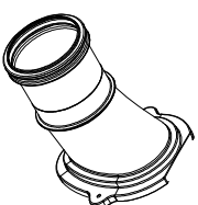
ACO Qmax 700 element za vezu muškog kraja kanala sa revizionim oknom
