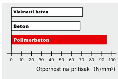
Otpornost na pritisak različitih materijala od kojih se proizvode kanali za odvodnjavanje.
