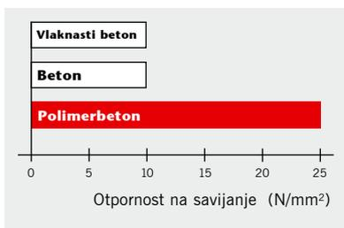
Otpornost na savijanje različitih materijala od kojih se proizvode kanali za odvodnjavanje.
