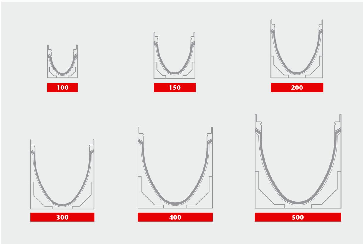
Veliki izbor materijala za sve nominalne veličine i klase opterećenja. Tri vrste zaštitnog ruba, od livenog gvožđa, pocinkovanog čelika ili nerđajućeg čelika, nude projektantu slobodan izbor rešetke koji omogućuje ostvarenje visokih estetskih zahteva. Zbog istovetnosti materijala nema opasnosti od nastajanja kontaktne korozije na spojevima rešetke i ruba.
