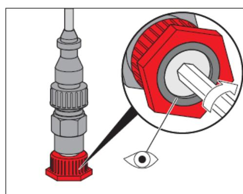
**UPOZORENJE** Nakon pada od >1m, senzorski utikači ne bi trebalo da se koriste. Utikači senzora moraju da se pričvrste ili otpuste samo pomoću crvene matice.
