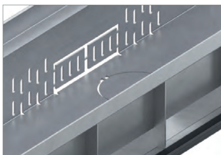
Detalj elementa kanala sa drenažnim prorezima
