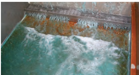
Ispitivanje tela kanala sa mrežastom rešetkom 30 x 10 mm, slobodna drenaža kao podignuti pod
