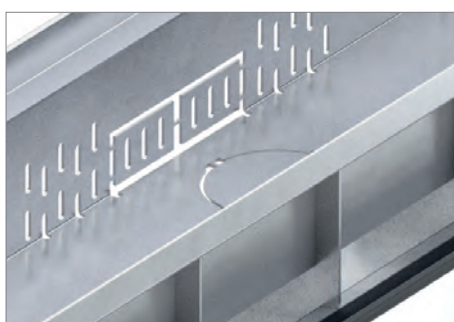
Detalj elementa kanala sa drenažnim prorezima
