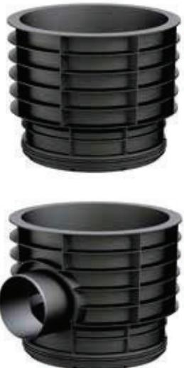
Postoje dva tipa elemenata za povišenje: povišenje sa ili bez cevnog priključka. Sva povišenja imaju integriranu naglavnu EPDM zaptivku koja osigurava vodonepropustnost spoja do 0,5 bar, visinsku podesivost  $\pm 30$  mm i mogućnost nagiba svakog elementa do 10 % za prilagođavanje nagibu terena.
