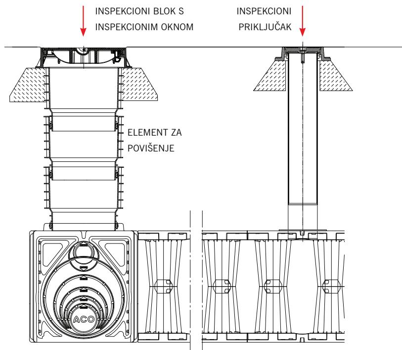
Element bez cevnog priključka (koji je najčešće u upotrebi) ostvaruje povišenje 27 cm, dok element sa cevnim priključkom osigurava visinu povišenja od 28 cm.
