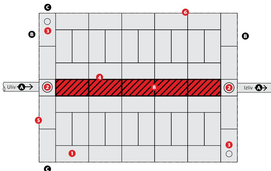
**ACO Stormbrixx retenzioni sistem sa sedimentacionim tunelom**
