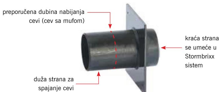
Cevni priključak se osloni na mestu priključka na postavljeni geotekstil kako bi se njegov unutrašnji prečnik octao (tačno mesto je jednostavno "napipati" zbog "propadanja" geotekstila na mestima gde su otvori izrađeni).
