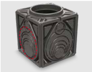
Šabloni za priključke ulivnih i izlivnih cevi nalaze se na svakoj stranici pristupne komore. U zavisnosti od zahteva iseca se i uklanja odgovarajući šablon. Drugi korak je isecanje panela, po šablonu za cev prečnika 375 mm sa svake strane komore, prema zahtevanom pristupu rezervoaru.
