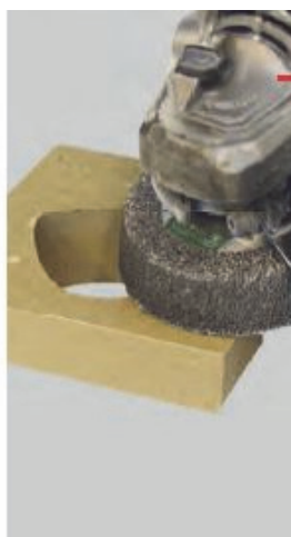
Priprema površine za lepljenje
