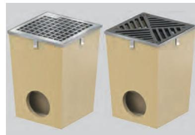
Links: Hofablauf aus Polymerbeton, mit Aufsteckzarge und Maschenrost, Stahl verzinkt, mit Kunststoff-Schmutzeimer, mit Öffnung DN 100 und herausnehmbarem Geruchsverschluss
