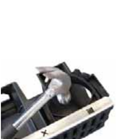
Formiranje bočnog izliva ili bočnog priključka
