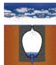
Počinje kiša, kanal počinje da se puni vodom i voda ističe preko regulatora protoka
