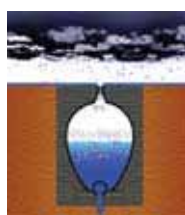
Nivo vode u Qmax® kanalu raste kako raste intenzitet padavina. Izliv dostiže projektovani regulisani protok bez plavljenja površine koja se odvodnjava
