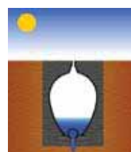
Oluja prolazi, kontrolisani izliv se nastavlja, a nivo vode u kanalu opada
