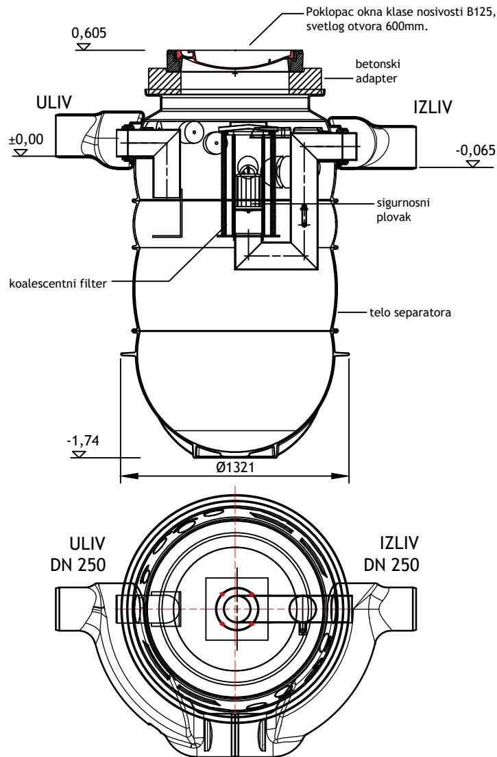
Prilikom montaže (slaganja) elemenata kontrolisati spojeve i njihovu nepropusnost.
