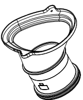
ACO Qmax 700 element za vezu ženskog kraja kanala sa revizionim oknom
