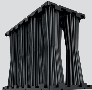
StormBrixx HD – Rezervoar za prikupljanje voda od olujnih događaja za uslove teškog saobraćaja, dizajniran za mesta gde su projektom zahtevane veće dubine instalacije i gde postoji izloženost podzemnim vodama. Ima maksimalnu dubinu ugradnje od 5.2 m, i takođe uključuje pristupne otvore za pregled i održavanje.
